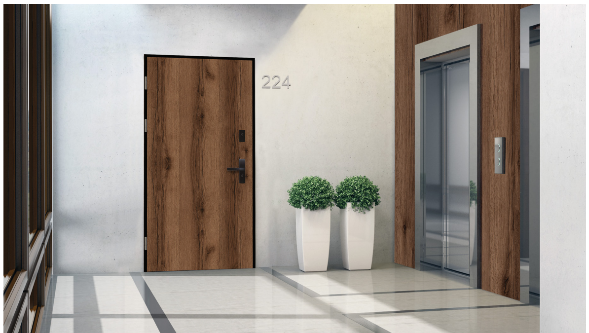
drzwi RC4 EI30, wzór 00, ościeżnica stała metalowa
